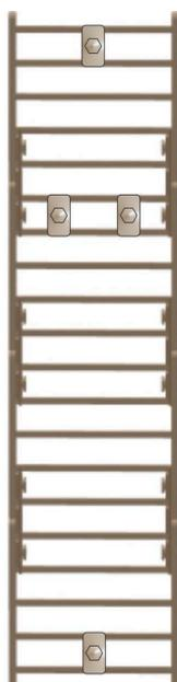
Für miteinander verbundene Konstruktionen empfehlen wir die Platzierung der Verbindungsstücke Wandhalterung W1 gemäß diesem Bild:
