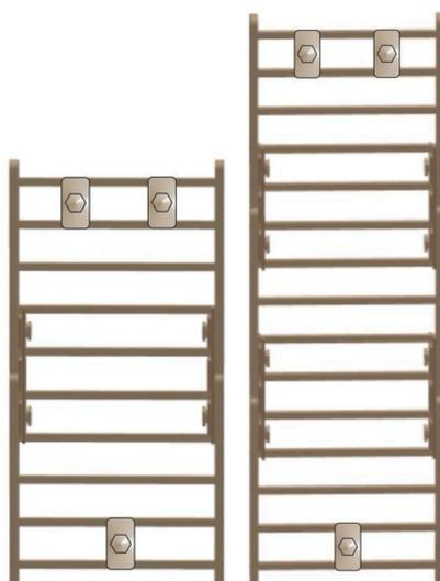
Für Konstruktionen aus vier Panels empfehlen wir, 4 Verbindungsstücke Wandhalterung W1 wie in diesem Bild anzuordnen:
